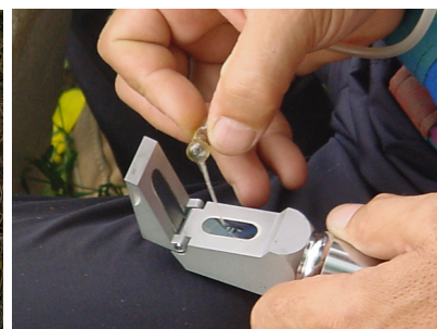
Figura 3. Determinarea concentrației nectarului în zahăr
